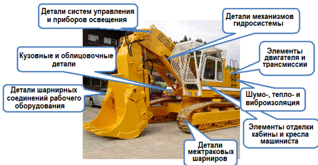
Рис. 5.6. Основные области применения полимерных материалов при производстве дорожно-строительных машин
